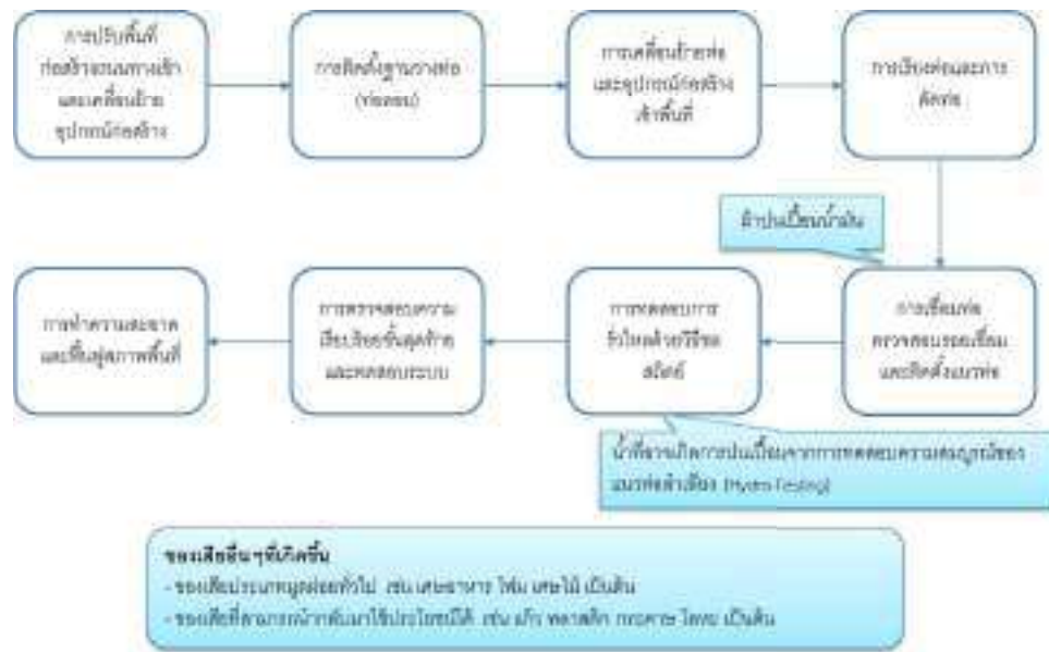
รูปที่ 2-22 แผนผังกระบวนการและแหล่งที่มาของของเสียในระยะก่อสร้างและติดตั้งท่อลำเลียง
