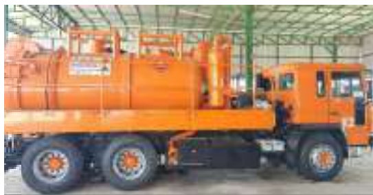
รูปที่ 3-20 ตัวอย่างรถสูบน้ำ (V-truck) จากบ่อกองกกริตที่รวมรวมน้ำที่อาจเกิดการปนเปื้อน
