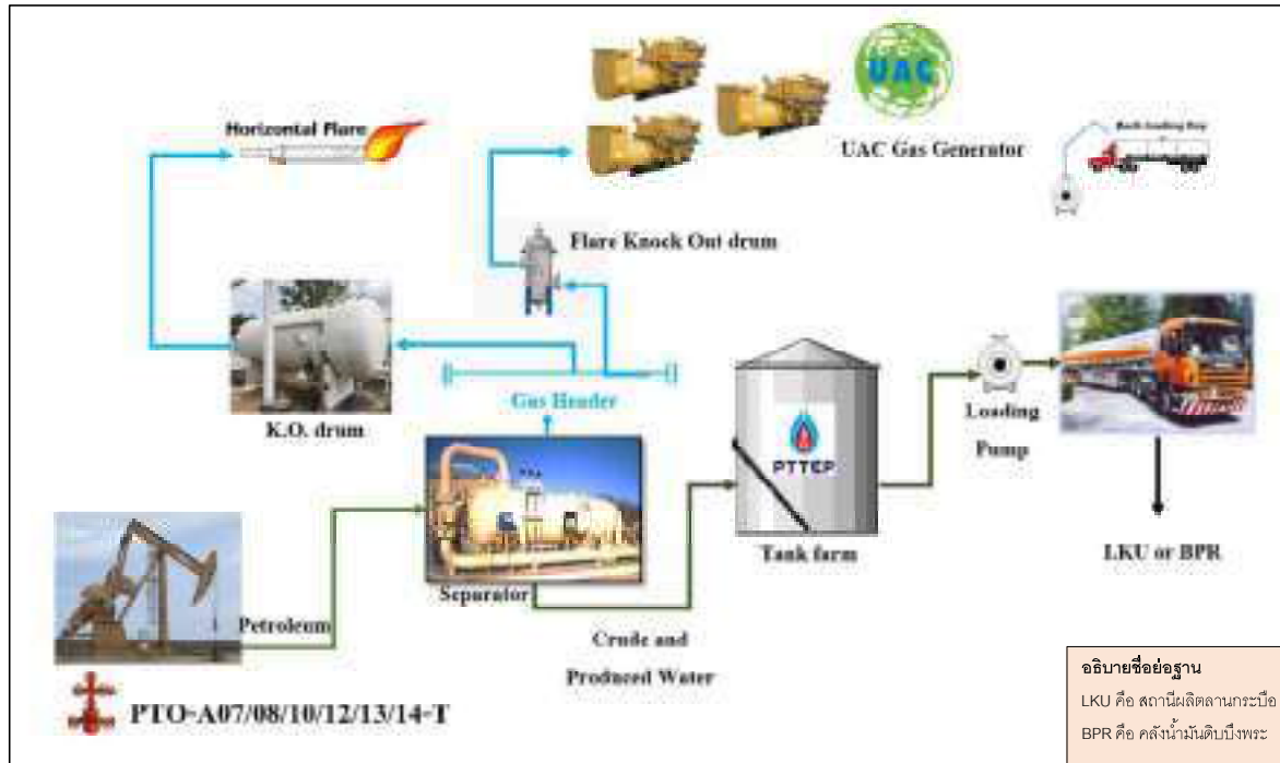
รูปที่ 2-7 แผนผังกระบวนการผลิตของฐานหลุมผลิตประตูเฝ้าเอ (PTO-A)
